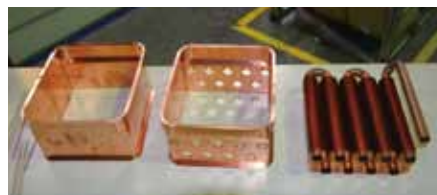
右が熱交換部(銅管を多数の銅製フィンに通す)、左がそれを入れる銅製の缶体
