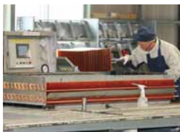
伝熱管にはU字に加工した銅管を フィンには大量の銅板を使用している
