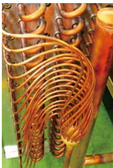
職人技で巧みに曲げ加工された分配管と 複数の熱交換器を繋ぐヘッダー管
