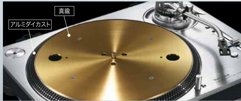
真鍮とアルミダイカスト、そしてラバーを強固に一体化することで振動を抑えこんでいる。質量に不均一な偏りがあると回転時に振動やノイズの原因となるため、新幹線の車輪製造時などに使用されるバランス調整機を応用してバランスを精密に調整している。
