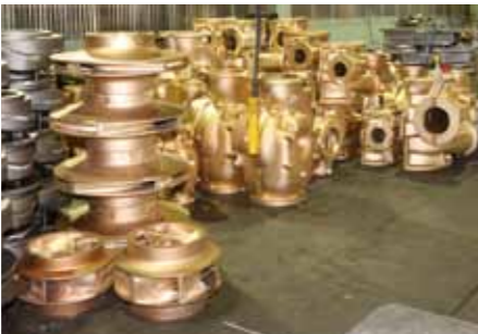
4 ケーシングのサイズは、タンカーの規模や用途に応じて様々で、中には人が入れるほどの大きな物も。他にもケーシングだけではなくインペラをはじめ、ポンプやタービンも構成する部品も銅合金製である。
