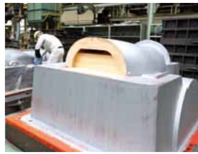
1 自動倉庫には約6000種の木型を格納。その中から1日約10パターンの鑄型を作る。
