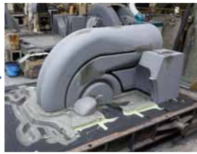
2 鑄型は、銅が浸み込まないように特殊塗料でコーティングし、焼き付きを防止する。
