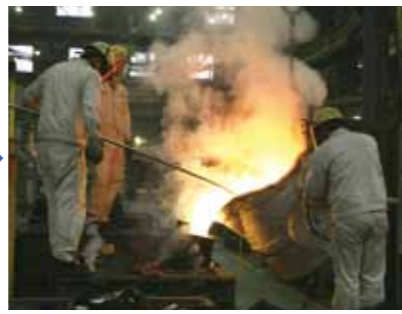
3 1240℃で溶かした銅合金を鑄型へ、空洞部分を充填するように鑄込む、冷却方法にも独自のノウハウがある。
