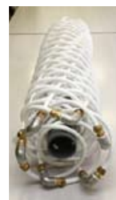
6本の銅管をスパイラルに加工、さらに芯をずらして組み合わせ、輪の隙間を埋めている
