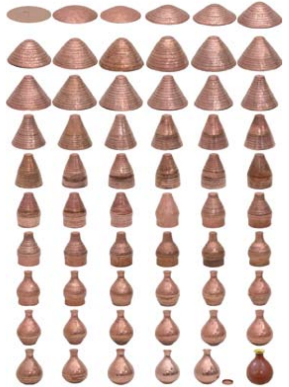
東京芸術大学 鍛金研究室の最初の制作課題。 円盤状の平らな銅板から回転体の花器を絞る60回の制作行程を示している。(学部2年生による制作)
