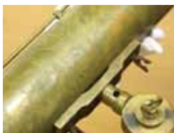
一貫斎の反射望遠鏡は、一部のねじ以外はすべて真鍮製
