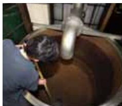
③仕込み 糖化槽でグリストを温水と 混ぜて糖化
