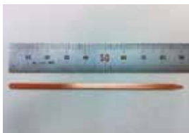
スマートフォンに採用されたヒートパイプは、極細の円筒のパイプを平らに潰してさらに薄くコンパクトに改良している
