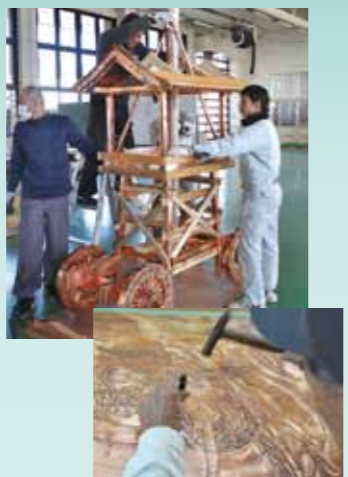
オール銅製鉾のミニチュア(上)、彫金による絵付け(下)
