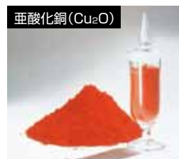
赤褐色の粉末顔料。海生生物の付着を防ぐ船底塗料として使用されている。
