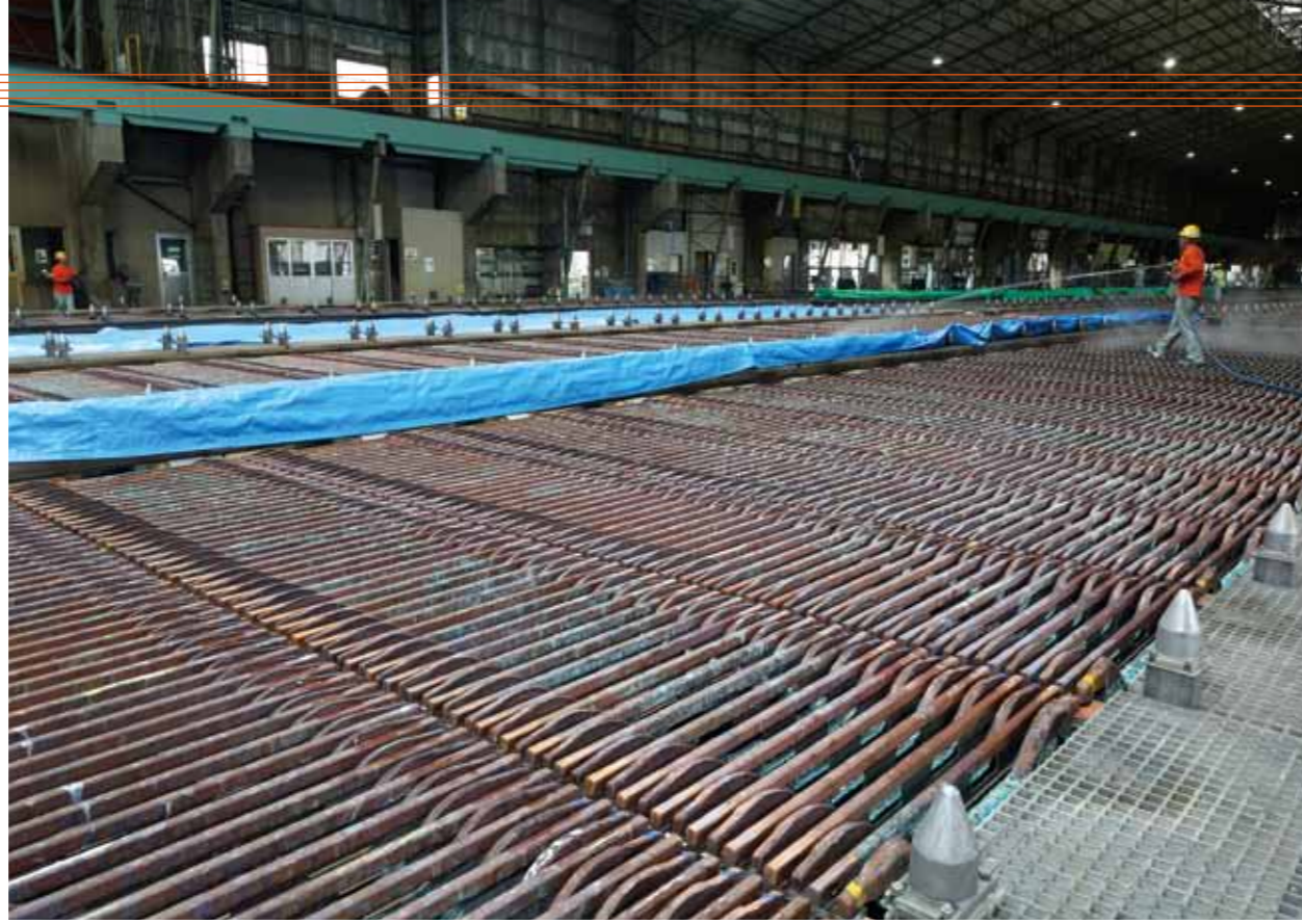
アノードを電解精製する工場には、768もの電解槽がずらりと並び！
