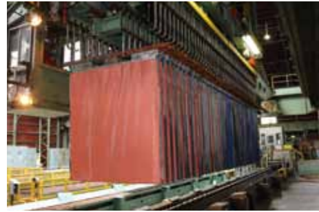
カソードの両面に電気銅の板が電着する
