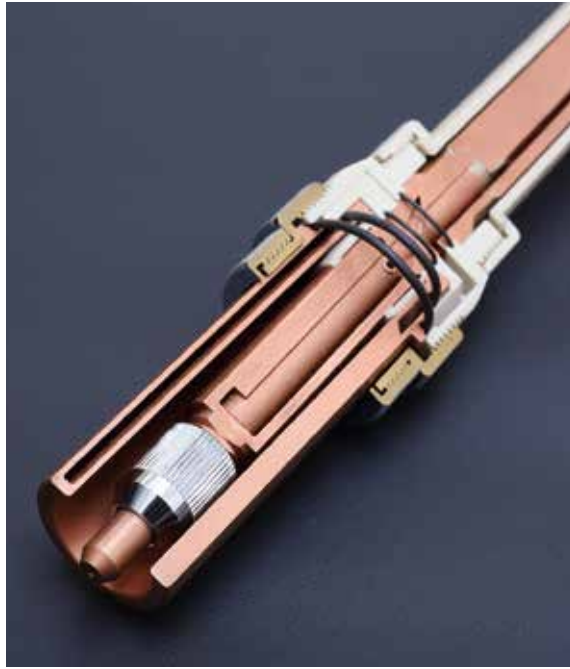
約30μの銅粉を一層ずつ積層しながら造形していく。
