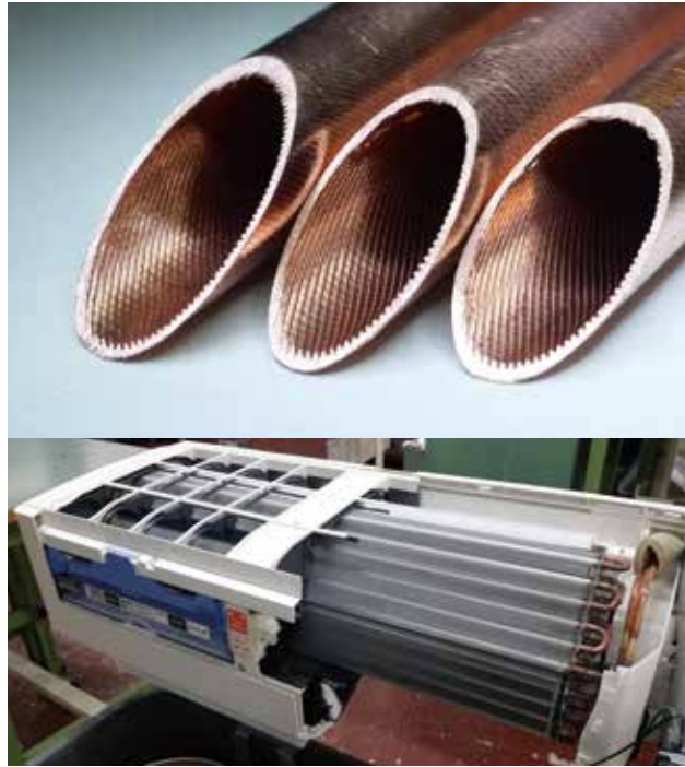
空調機とそこに多用される内面溝付き銅管
