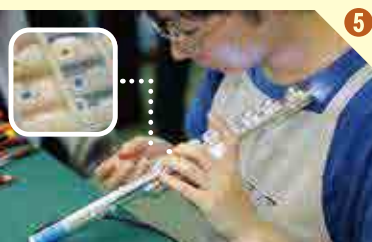
キィが精密に作動し、正しい音程を奏でるかを最終調整
