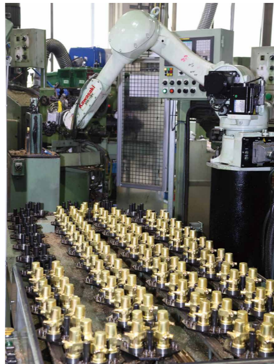
緻密に計算し尽くされた加工プログラムにより、精巧で均質な切削加工を実現。何台ものロボットが、小気味良いテンポで次々と黄銅製のバルブボディを供給している
