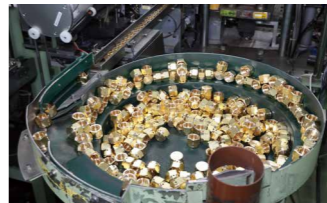
バルブを構成する部品、黄銅製の安全弁ナット
