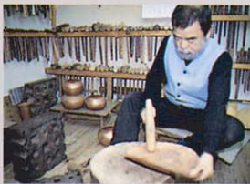
「張り出し」たたいて浅い皿状にする。武久さんは銅板を自在に操る
