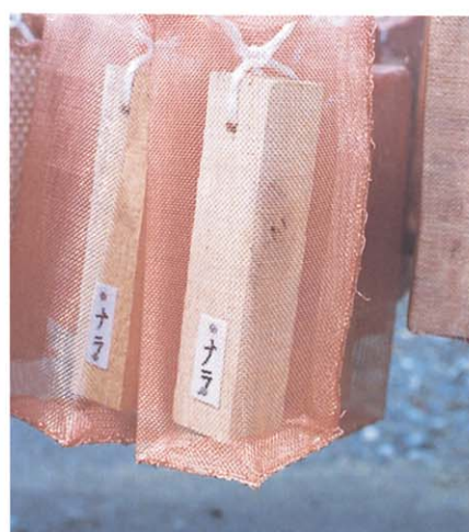
暴露試験(銅ネットによる木片防虫調査)
