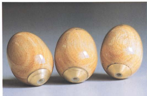
塗装前の中通しウキ。下部に真鍮の錘が組み込んである。
