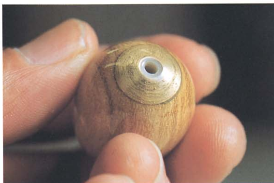
塗装前の中通しウキ。下部に真鍮の錘が組み込んである。
