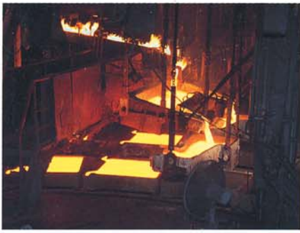
三菱連続製銅炉。地球にやさしく、経済的な銅製錬法として世界中から注目を集めている。
