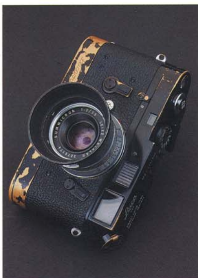
1960年代中盤に登場したライカM4。私が最も好きなライカである。長年の使用のためボディ下部は真鍮地が露出してしまっている。全体の印象からすれば、満身創痍だが性能的には何ら問題なく、道具としての迫力すら感じさせる。
