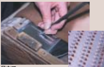
目立て 規則的なリズムで鑿が打ち込まれ、瞬く間に目が立っていき
