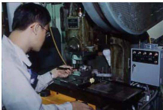
プレス機による圧着作業。ヒーロー電機伝統の圧着技術により、バッテリーターミナルと銅線がきれいに固定される。
