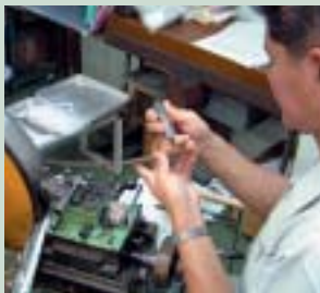
帯状の黄銅板をマイクロン単位の精度で削り出す
