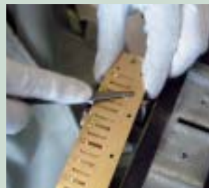
最高の音で鳴るように職人の手でひとつひとつ調整される
