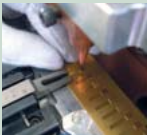
プレートの加工形状もハーモニカの基本性能に大きく影響する
