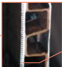
白い断面の小さな穴が内径0.5mmの微細チューブ。これが150本連なっている
