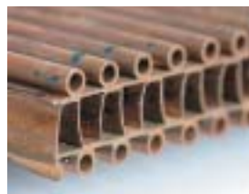
03年には微細チューブが銅管に、オフセットフィンがハニカムプレートに変更され、内側を水が通り、外側をCO 2 が通るように改良されている
