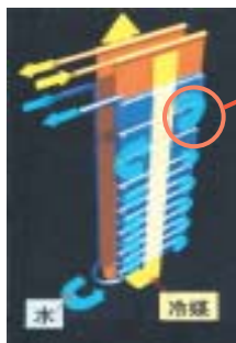
01年に完成された水冷媒熱交換器。内側の微細チューブをCO 2 が通り、外側のプレート間を水が流れる。プレート間にはオフセットフィンが挟まれている
