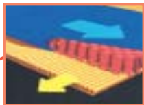
01年に完成された水冷媒熱交換器。内側の微細チューブをCO 2 が通り、外側のプレート間を水が流れる。プレート間にはオフセットフィンが挟まれている
