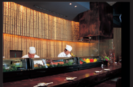
レンジフードにも銅板を使用
