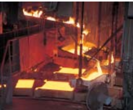
スラグ・メタルは連続製銅炉に投入され、粗銅に仕上げられる
