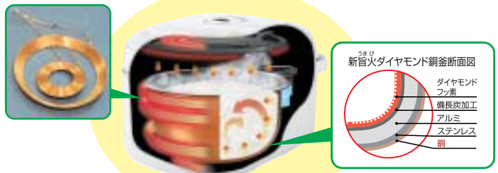
銅コイルに電流を流すと磁力線が発生し、釜が発熱する
