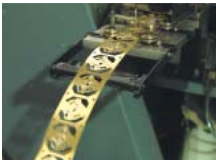
微細に打ち抜き加工された真鍮条がつぎつぎと加工機に送り込まれてゆく
