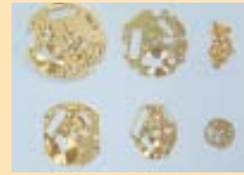
精密に成形加工された ムーブメント部材
