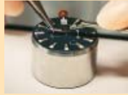
時計に命を吹き込む最後の仕上げ。 文字盤や針、ケースなどを取り付ける
