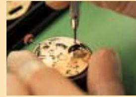
年差±5秒を実現した高性能ムーブメントの組み立ては、数ミクロン単位の 作業となる。指の震えもゆるぎない。
