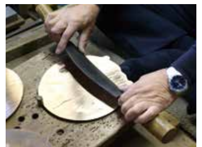
「セン」でさらに1mm以下にまで削る
