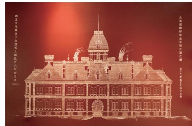
昭和43年の復元工事は図面が焼失して見つからず、古写真を目視しての工事となった。復元工事後に奇跡的に立面図が見つかったが、立面図とほぼ変わらない正確さであったという。これはその立面図。
